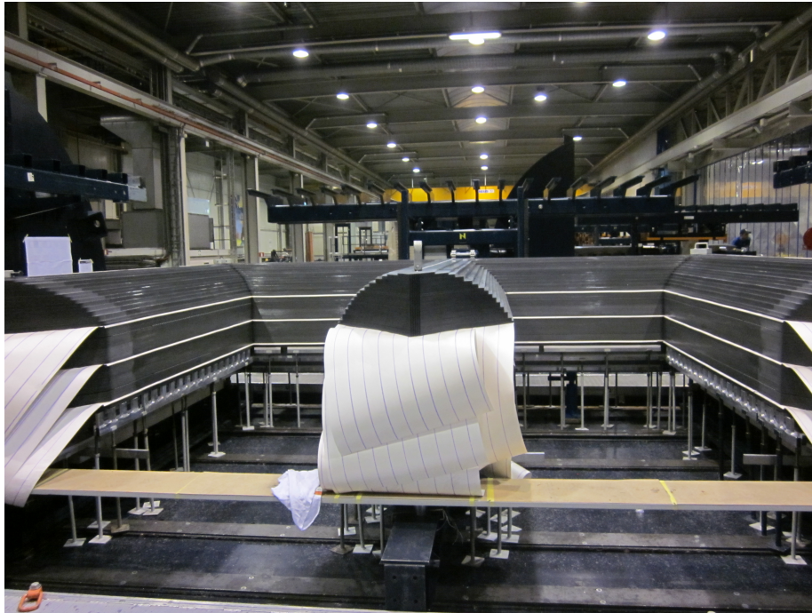
Figuur 2: Laagjes blik vormen samen de kern van een transformator
