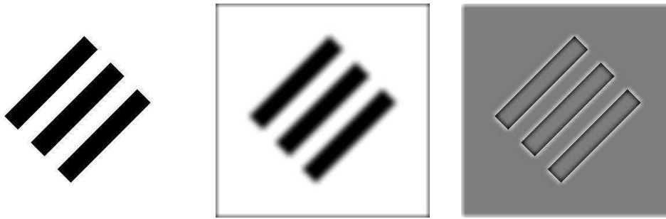
Figuur II.15: Origineel, low-pass en high-pass gefilterd versie van een eenvoudig plaatje.
